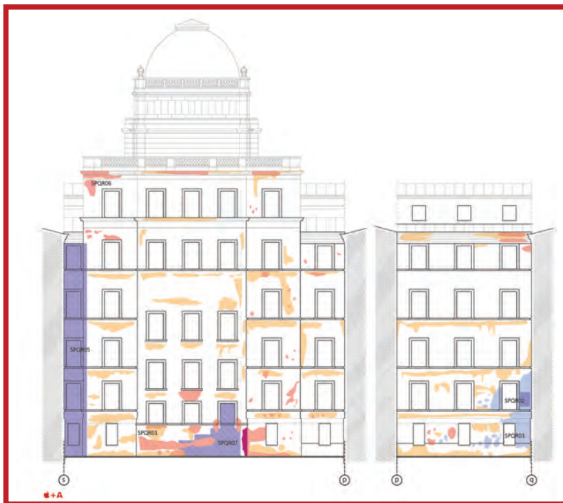
Fotografija 41. Skica sa označenim oštećenjima na objektu (najčešće uzorkovana udarom (ratna razaranja) uz druge faktore. (&+A) – Ammar Akšamija, Dženis Avdić i / “Arhiv Akšamija” Sarajevo, 2021)
